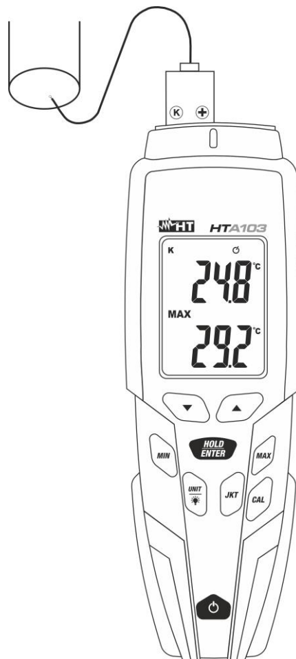
Fig. 5: Uso dello strumento per misura della temperatura
