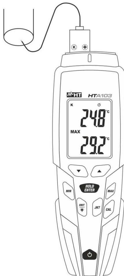
Abb. 5: Verwendung des Messgerätes bei der Temperaturmessung
