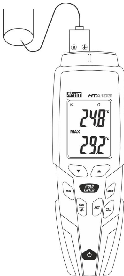
Fig. 5: Utilisation de l'instrument pour la mesure de la température
