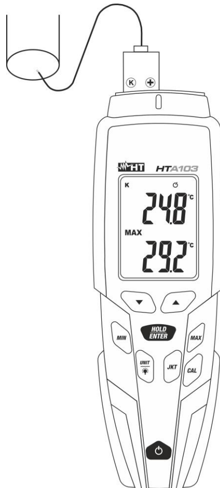
Fig. 5: Uso del instrumento para la medida de la temperatura
